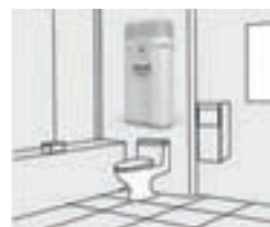
filter inštalovaný nad WC
